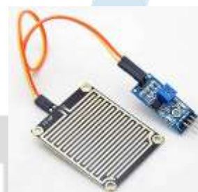
Fig (1). Rain Sensor
